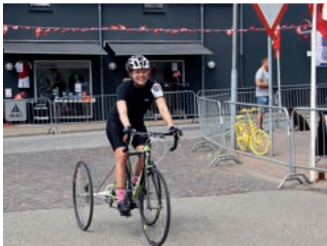
Emma deltager i sportsklassen T2. Det er en ordinær landevejscykel, der er sat op med en bagaksel med to baghjul. Det betyder, at cyklen sikrer stabilitet og støtter rytterens balance.
